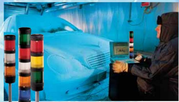
Тестом на прочность и одновременно подтверждением качества исполнения пятиступенчатой лампы BR 50 является климатическая камера одного из ведущих поставщиков автомобилей. Здесь лампа используется для сигнализации о прохождении испытаний под нагрузкой различных компонентов автомобилей (при температурах от - 40°C до +100°C и 100% влажности).
